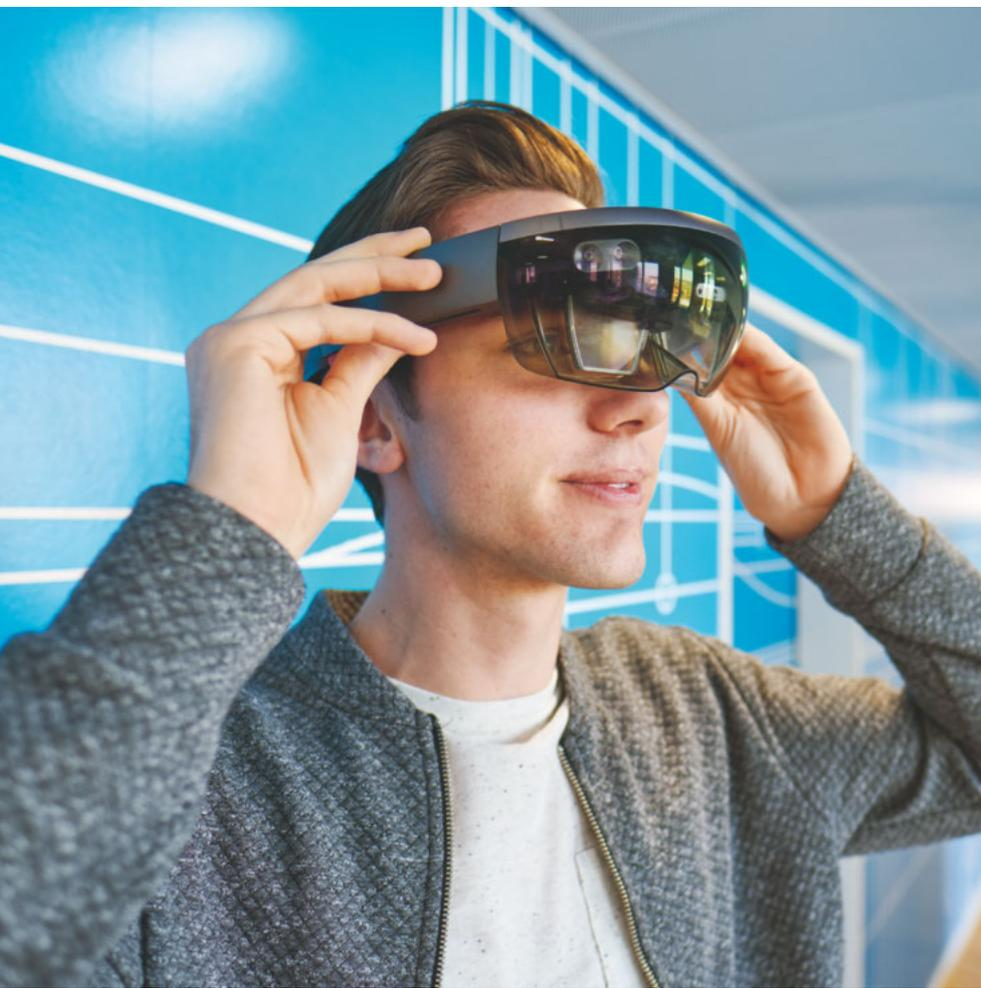
**Réalité mixte : grâce à ce casque, des plans numériques peuvent être transposés directement dans l'espace, ce qui permet de les visualiser plus facilement.**
